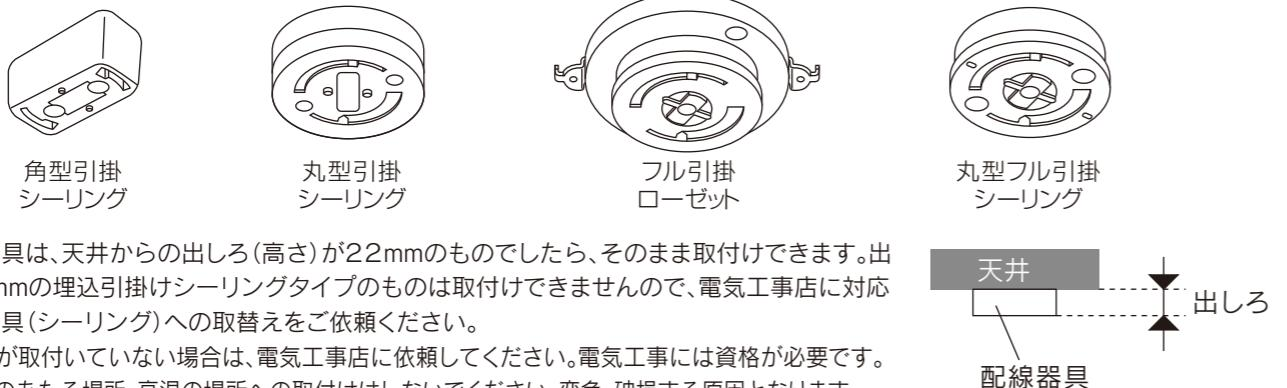
天井配線器具は、天井からの出しろ(高さ)が22mmのものでしたら、そのまま取付けできます。出しろが11mmの埋込引掛けシーリングタイプのものは取付けできませんので、電気工事店に対応する配線器具(シーリング)への取替えをご依頼ください。
