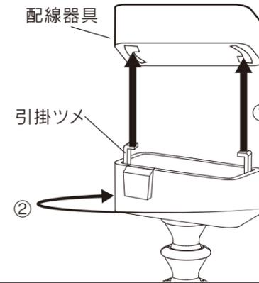
2. ランプソケットにLED電球を取付ける
